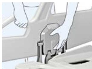
Pulsante di sblocco che garantisce la rimozione sicura delle sponde in plastica
